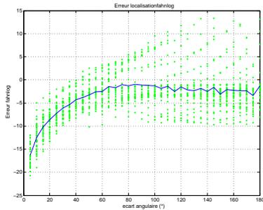
FIG. A.4 – Erreur de localisation mesurées pour le critère Fahn logarithmique : l’axe des abscisses représente l’écart angulaire en degrés entre les HRTF de la paire obtenue. Pour un même écart angulaire, les résultats sont moyennés sur toutes les paires évaluées (courbe en trait continu), l’ensemble des valeurs obtenues est également reproduit par des pointillés.
