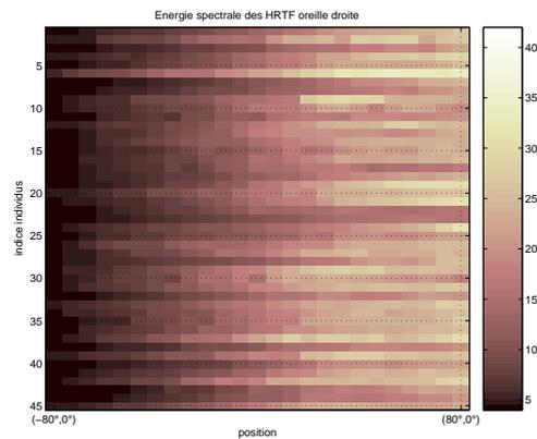
FIG. C.4 – Energie spectrale des 25 HRTF (celles mesurées à partir de l’oreille droite sur le plan horizontale) de tous les individus de la base : l’axe des abscisses représente l’azimuth en lequel les HRTF ont été mesurés sur le plan horizontale(l’élévation est constante et nulle), l’ordonnée représente le numéro d’individus sur lequel ont été mesurées les HRTF, et le niveau de gris est associée à la valeur de l’énergie de l’HRTF mesurée.
