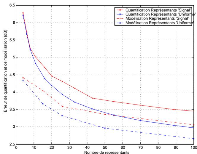
FIG. 1.7 – Resultats 2004 : Les erreurs de modélisation sont plus faibles que les erreurs de quantification. Les représentants uniformément répartis à la surface de la sphère offrent de meilleurs erreurs que les représentants calculés par notre méthode de clustering.
