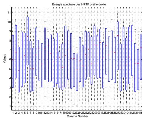
FIG. C.6 – Boxplot sur les Energie spectrale des 25 HRTF (celles mesurées à partir de l’oreille droite sur le plan horizontale) de tous les individus de la base.
