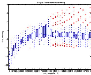
FIG. 2.6 – Erreur de localisation mesurées pour le critère Fahn logarithmique : l'axe des abscisses représente l'écart angulaire en degrés entre les HRTF de la paire obtenue. Pour un même écart angulaire, les résultats sont moyennés sur toutes les paires évaluées (courbe en trait continu), l'ensemble des valeurs obtenues est également reproduit par des pointillés.
