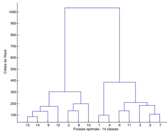
FIG. 3.5 – Exemple de dendrogramme. La base de l’arbre est composée de 144 clusters. A chaque étape de la construction de l’arbre, on regroupe les deux clusters les plus proches. Le sommet de l’arbre contient un seul cluster
