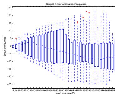
FIG. 2.5 – Erreur de localisation mesurées pour le critère Chocqueuse : l'axe des abscisses représente l'écart angulaire en degrés entre les HRTF de la paire obtenue. Pour un même écart angulaire, les résultats sont moyennés sur toutes les paires évaluées (courbe en trait continu), l'ensemble des valeurs obtenues est également reproduit par des pointillés.
