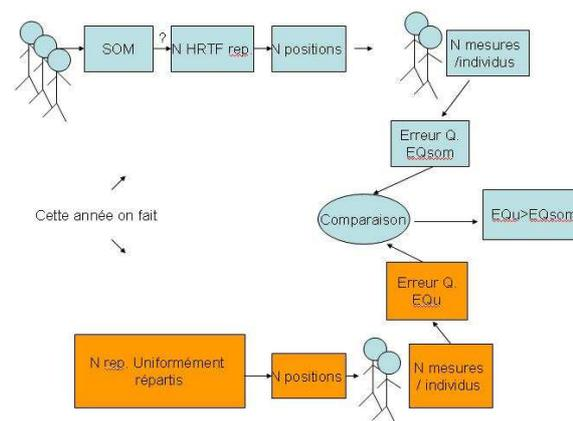
FIG. 1.8 – Schéma bloc décrivant l'étude réalisée en 2005. Equ est l'erreur de quantification calculée avec les représentants uniformes. Eqsom est l'erreur de quantification calculée avec les représentants issus de notre méthode de clustering (utilisant des cartes auto-organisatrices de Kohonen : SOM).
