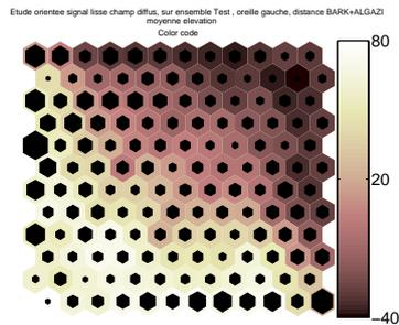
FIG. 3.16 – Moyenne de l'élévation sur la carte de l'hémisphère avant : Les hexagones clairs correspondent à des neurones contenant en moyenne des HRTF situées à des élévations élevés ( $90^\circ$ ) et les hexagones sombres, à des neurones contenant en moyenne des HRTF situées à des élévations faibles ( $-50^\circ$ ).
