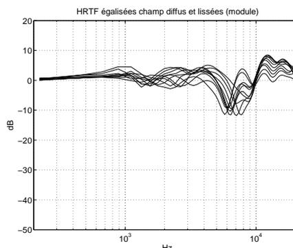
FIG. 1.6 – HRTF égalisées champ diffus et lissées : pour une élévation nul et des azimuts qui varient entre  $-80^\circ$  et  $-15^\circ$ . L'axe des abscisses représente les fréquences en Hz, les ordonnées présente le gain en dB
