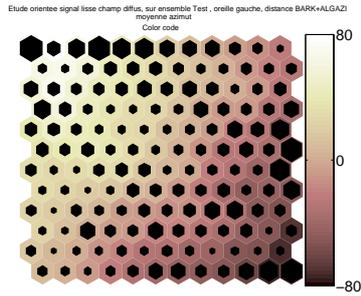
FIG. 3.11 – Moyenne de l'azimut : Les hexagones clairs correspondent à des neurones contenant en moyenne des HRTF situées à des azimuts élevés ( $+80^\circ$ ) et les hexagones sombres, à des neurones contenant en moyenne des HRTF situées à des azimuts faibles ( $-80^\circ$ ).
