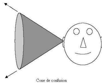
FIG. 1.1 – Le cône de confusion : tous les points pris sur un cercle appartenant à la surface de ce cône ont des ITD et ILD confondus.
