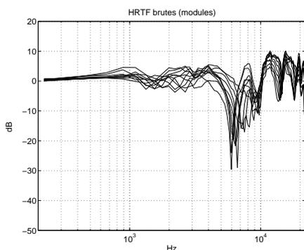
FIG. 1.5 – HRTF Brutes (modules) : pour une élévation nul et des azimuts qui varient entre  $-80^\circ$  et  $-15^\circ$ . L'axe des abscisses représente les fréquences en Hz, les ordonnées présente le gain en dB.
