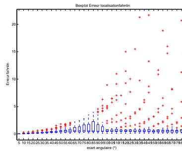
FIG. 2.7 – Erreur de localisation mesurées pour le critère Fahn linéaire : l'axe des abscisses représente l'écart angulaire en degrés entre les HRTF de la paire obtenue. Pour un même écart angulaire, les résultats sont moyennés sur toutes les paires évaluées (courbe en trait continu), l'ensemble des valeurs obtenues est également reproduit par des pointillés.
