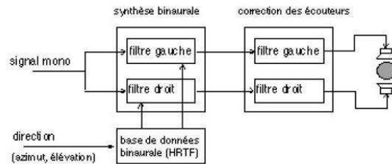
FIG. 1.3 – Principe de restitution binaurale à partir d'un enregistrement
