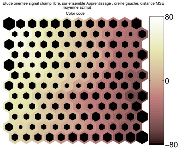
FIG. 3.3 – Visualisation des moyennes des azimuts sur une carte de Kohonen de taille  $12 \times 12$ . Les hexagones clairs correspondent à des neurones contenant en moyenne des HRTF situées à des azimuts élevés ( $+80^\circ$ ) et les hexagones sombres, à des neurones contenant en moyenne des HRTF situées à des azimuts faibles ( $-80^\circ$ ).
