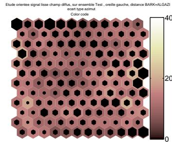
FIG. 3.12 – Ecart type de l'azimut : Les hexagones clairs correspondent à des neurones contenant des HRTF situées à des azimuts éloignées et les hexagones sombres, à des neurones contenant des HRTF situées à des azimuts proches.
