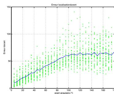
FIG. A.2 – Erreur de localisation mesurées pour le critère Durant. : l'axe des abscisses représente l'écart angulaire en degrés entre les HRTF de la paire obtenue. Pour un même écart angulaire, les résultats sont moyennés sur toutes les paires évaluées (courbe en trait continu), l'ensemble des valeurs obtenues est également reproduit par des pointillés.
