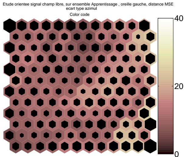
FIG. 3.4 – Visualisation des écarts-types des azimuts sur une carte de Kohonen de taille  $12 \times 12$ . Les hexagones clairs correspondent à des neurones contenant des HRTF situées à des azimuts éloignées et les hexagones sombres, à des neurones contenant des HRTF situées à des azimuts proches.
