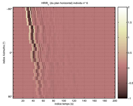
FIG. C.1 – Projection des 25 HRIR (celles du plan horizontale) mesurées sur l'oreille gauche de l'individu 6. L'axe des abscisses représente le temps, l'axe des ordonnées représente l'azimuth à laquelle l'HRIR a été mesurée tandis que le niveau de gris renseigne sur l'amplitude de la HRIR.
