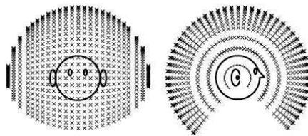
FIG. 1.2 – Position des points de mesures utilisés par le CIPIC (Center Image Processing and Integrated Computing) : Les croix représentent les différentes positions qu'occupent les Haut-Parleurs du dispositif de mesure d'HRTF.
