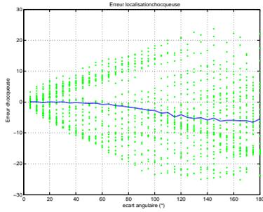
FIG. A.3 – Erreur de localisation mesurées pour le critère Chocqueuse : l’axe des abscisses représente l’écart angulaire en degrés entre les HRTF de la paire obtenue. Pour un même écart angulaire, les résultats sont moyennés sur toutes les paires évaluées (courbe en trait continu), l’ensemble des valeurs obtenues est également reproduit par des pointillés.
