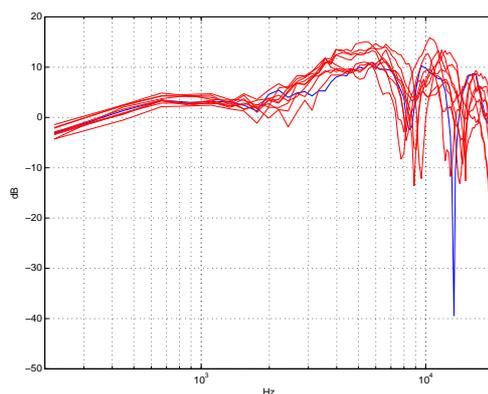
FIG. 2.10 – Caractérisation de l'erreur d'individualisation : on constate que les HRTF mesurées sur un même position mais pour des individus différents se traduisent sur l'axe fréquentiel
