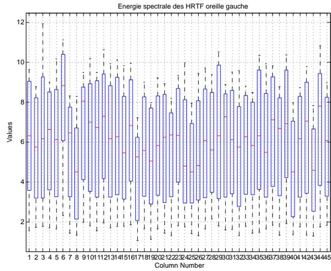
FIG. C.5 – Boxplot sur les distributions d’Energies spectrales des 25 HRTF (celles mesurées à partir de l’oreille gauche sur le plan horizontale) de tous les individus de la base.
