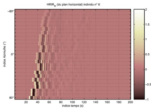
FIG. C.2 – Projection des 25 HRIR (celles du plan horizontale) mesurées sur l'oreille droite de l'individu 6. L'axe des abscisses représente le temps, l'axe des ordonnées représente l'azimuth à laquelle l'HRIR a été mesurée tandis que le niveau de gris renseigne sur l'amplitude de la HRIR.
