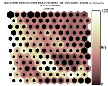
FIG. 3.15 – Ecart type élévation : Les hexagones clairs correspondent à des neurones contenant des HRTF situées à des élévations éloignées et les hexagones sombres, à des neurones contenant des HRTF situées à des élévations proches.
