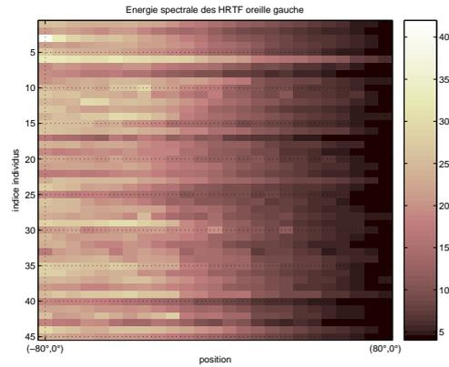
FIG. C.3 – Energie spectrale des 25 HRTF (celles mesurées à partir de l’oreille gauche sur le plan horizontale) de tous les individus de la base : l’axe des abscisses représente l’azimuth en lequel les HRTF ont été mesurés sur le plan horizontale(l’élévation est constante et nulle), l’ordonnée représente le numéro d’individus sur lequel ont été mesurées les HRTF, et le niveau de gris est associée à la valeur de l’énergie de l’HRTF mesurée.
