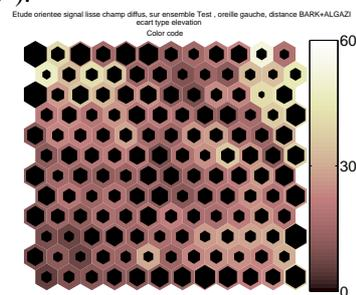
FIG. 3.19 – Ecart type de l'élévation sur la carte de l'hémisphère arrière : Les hexagones clairs correspondent à des neurones contenant des HRTF situées à des élévations éloignées et les hexagones sombres, à des neurones contenant des HRTF situées à des élévations proches.
