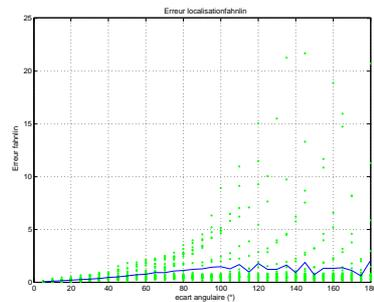
FIG. A.5 – Erreur de localisation mesurées pour le critère Fahn linéaire : l’axe des abscisses représente l’écart angulaire en degrés entre les HRTF de la paire obtenue. Pour un même écart angulaire, les résultats sont moyennés sur toutes les paires évaluées (courbe en trait continu), l’ensemble des valeurs obtenues est également reproduit par des pointillés.
