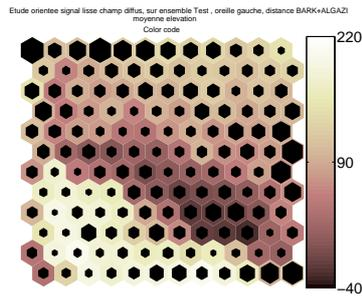
FIG. 3.14 – Moyenne de l’élévation : Les hexagones clairs correspondent à des neurones contenant en moyenne des HRTF situées à des élévations élevées ( $230^\circ$ ) et les hexagones sombres, à des neurones contenant en moyenne des HRTF situées à des élévations faibles ( $-50^\circ$ ).
